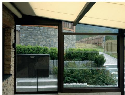
Il sistema di pareti tutto vetro saliscendi E.Biasi è dotato di un telaio in alluminio di alta qualità ed di un design attraente e sottile. Gli elementi del sistema scorrono in verticale sovrapponendosi uno su l'altro. L'apertura e chiusura ad uno o più elementi con parapetto o sopra luce fisso avviene tramite il motore incasato nella parte alta o nella parte bassa della struttura.
